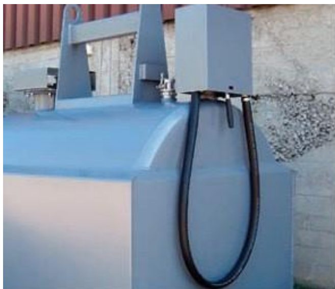
Kuva 6. Varastointiin ja kuljetukseen hyväksytty IBC-pakkaus, jossa on nostosanka ja käsipumppu. (Kuva: Pirkanmaan ELY-keskus)
