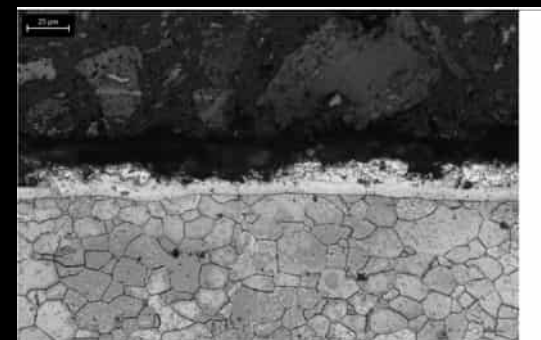
Kuva B.13 – Referenssiikiukaan lämpötilassa T = 500\text{ °C} pidetyn näytteen mikrorakennetta.
