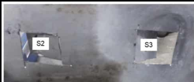
Kuva A.5 – Metallografisten näytteiden S2 ja S3 sijainti onnettomuuskiukaan takalevyssä.
