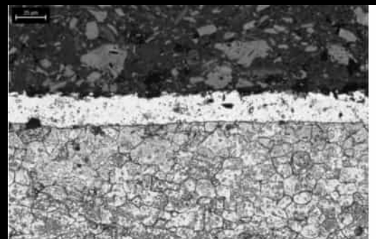
Kuva B.11 – Referenssiikiukaan lämpötilassa T = 400\text{ °C} pidetyn näytteen mikrorakennetta.
