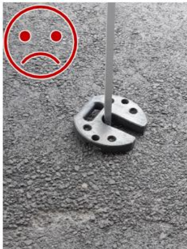
Bild 7. En annan motsvarande vikt saknas på den motsatta sidan liksom låsning av dessa till varandra, varvid de även skulle låsas i stolpen. Att hålen passar ihop med tyngdkraften räcker inte för att låsa.
