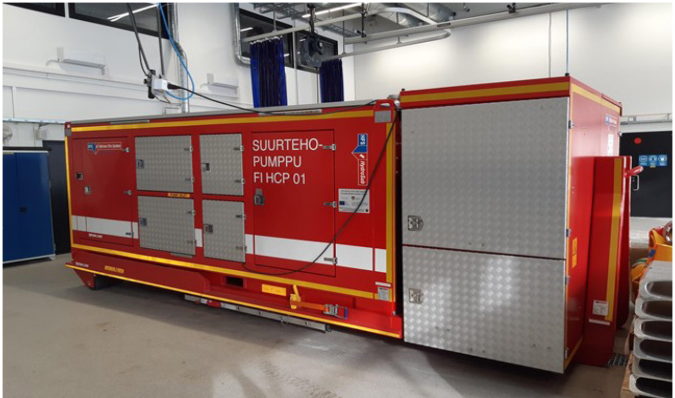
Kuva: Mika Haverinen Oulu-Koillismaan pelastuslaitos. Kuvassa suuretehopumppu HS 250 kuljetusalustalla
